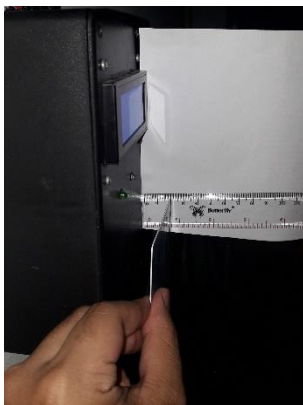
Gambar 4.2 Pengujian Jarak E-KTP Dengan Sensor RFID Dalam Box
