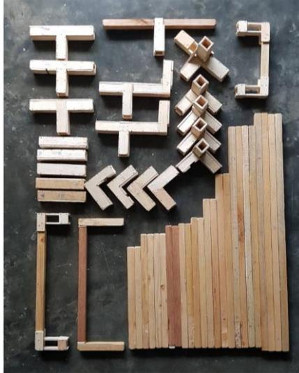
Gambar 5.14.5 Batang kayu dan sambungan untuk kerangka
