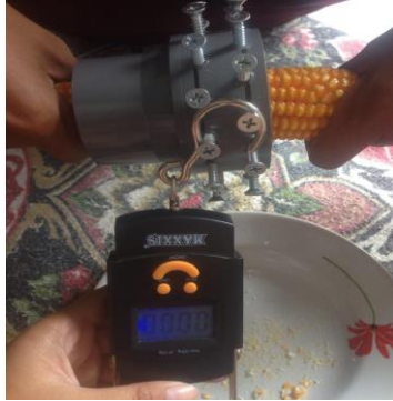
Gambar 3-2 Pengujian untuk mencari gaya pipil jagung
