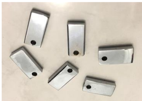
Gambar 3.6 Spesimen ST 41 yang sudah Terlapisi Nickel Chrome (NiCr)
