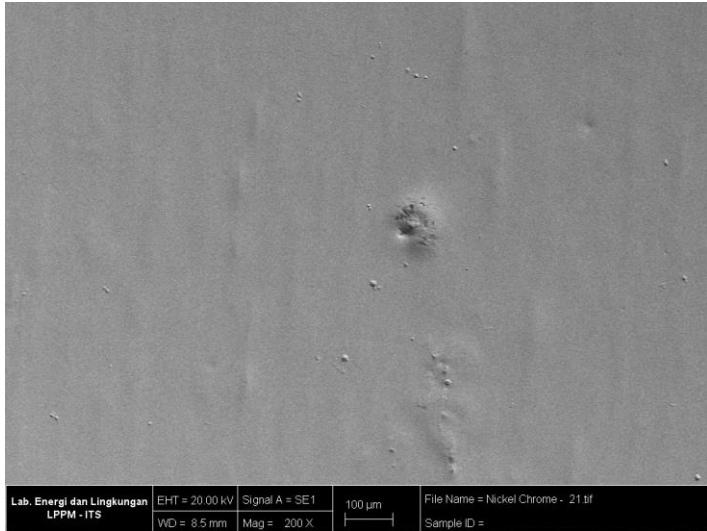
Gambar 3 Hasil pengujian SEM NiCr perbesaran 200x waktu perendaman 12 jam
