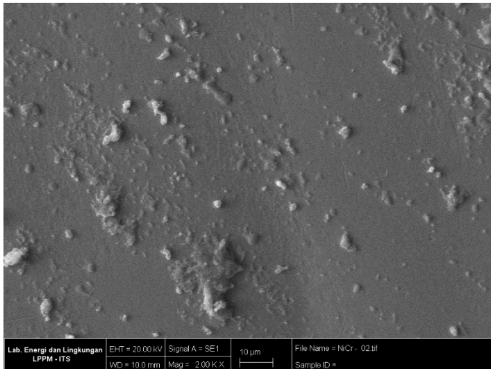
Gambar 12 Hasil pengujian SEM NiCr perbesaran 2000x waktu perendaman 336 jam
