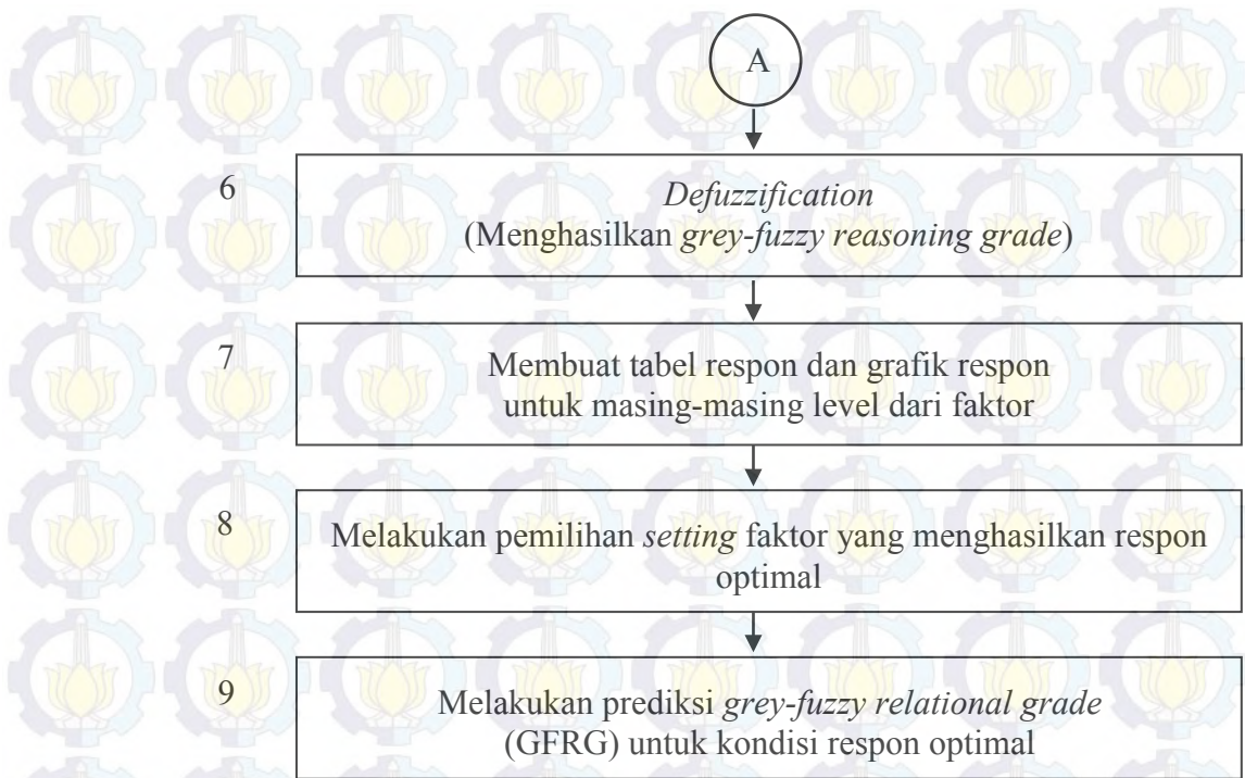
Gambar 2.15 Langkah-langkah Optimasi Taguchi-Grey-Fuzzy (lanjutan)
