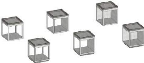
MODUL PREFABRICATED BERUKURAN 2,4 M X 2,4 M X 2,4 M INI MENGGUNAKAN MATERIAL BETON PRECAST DAN MODULE PARTISI BERUPA JENDELA DAN PINTU YANG TERBURAT DARI KOMBINASI MATERIAL ALUMINIUM, KAYU DAN KACA. DENGAN MENGGUNAKAN SISTEM STRUKTUR BOX, DALAM PENYUSUNAN MODUL AKAN TERJADI INTERLOCKING ANTAR MODULE. SISTEM STRUKTUR BOX DENGAN KARAKTER INTERLOCKING MEMPERMUDAH PENYUSUNAN DAN PELAKUKAN SESUAI KONSEP EKO-MODULAR YANG DIUSULKAN.
