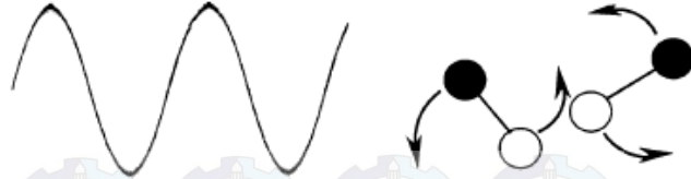
Gambar 2. 2 Molekul dipolar yang mencoba untuk mensejajarkan dengan medan elektrik yang berosilasi. (Lidstrom, 2001)
