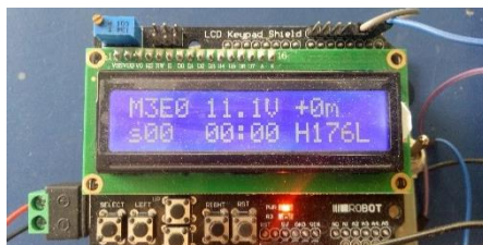
Gambar 4. 8 Selatan Hasil Data Kompas HMC5883L
