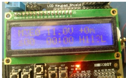
Gambar 4. 10 Timur Hasil Data GPS HMC5883L
