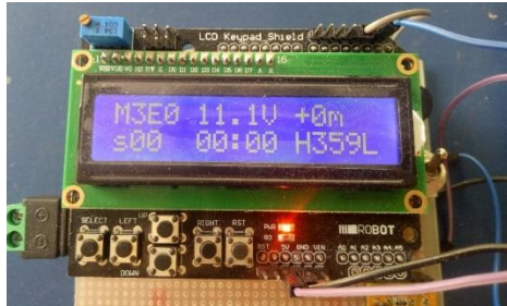
Gambar 4. 6 Utara Hasil Data Kompas HMC5883L
