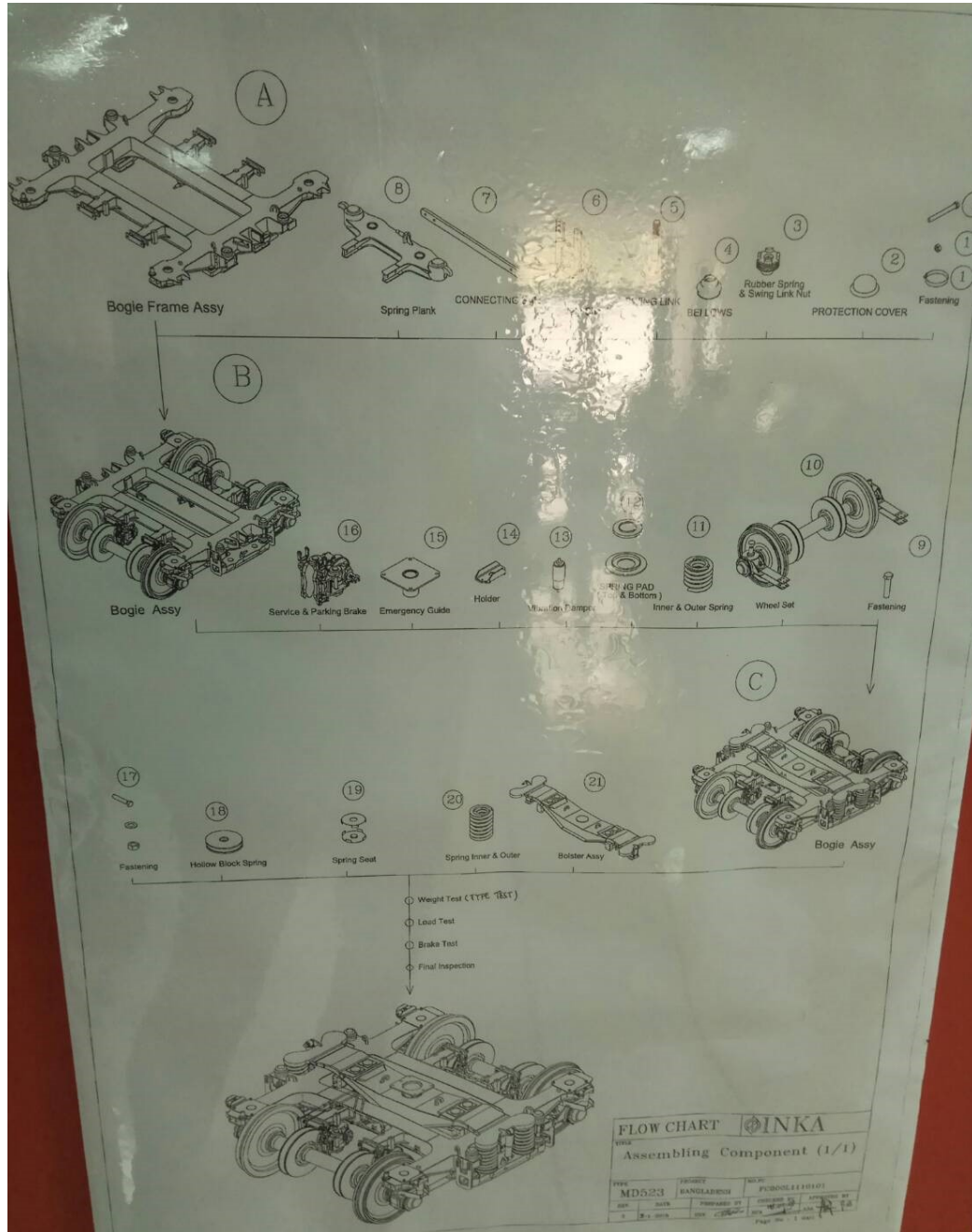
Gambar 4. 31 Flowchart Produksi Bogie Sumber : PT.INKA
