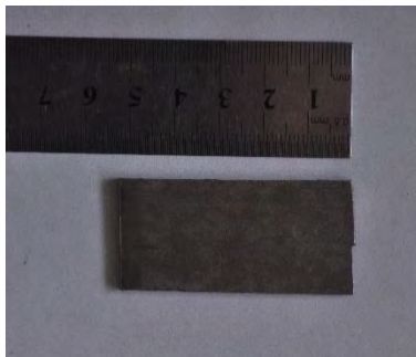
Gambar 3.3 Spesimen uji korosi pitting dan crevice
