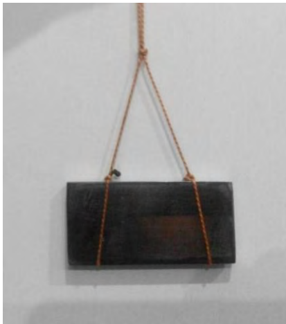
Gambar 3.8 Pemasangan benang nylon pada spesimen uji korosi pitting
