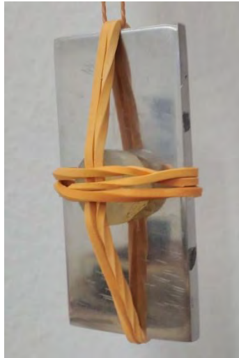
Gambar 3.9 Pemasangan TFE-fluorocarbon pada spesimen uji
