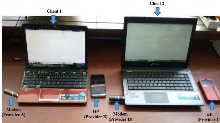
Gambar 3.2 Konfigurasi alat untuk pengukuran delay
