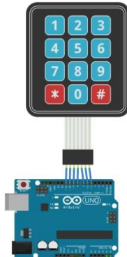
Gambar 3. 4 Wiring Arduino dengan Keypad 3x4
