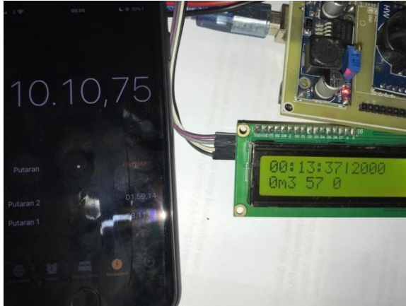
Gambar 4. 21 Pengujian Water Flow Reed Switch Sensor menit ke-10
