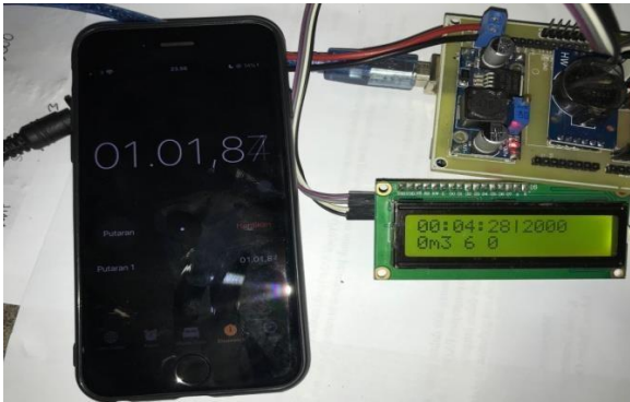
Gambar 4. 12 Pengujian Water Flow Reed Switch Sensor menit ke-1
