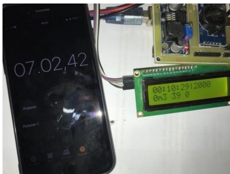
Gambar 4. 18 Pengujian Water Flow Reed Switch Sensor menit ke-7
