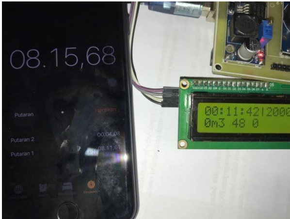
Gambar 4. 19 Pengujian Water Flow Reed Switch Sensor menit ke-8
