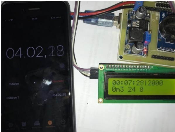
Gambar 4. 15 Pengujian Water Flow Reed Switch Sensor menit ke-4
