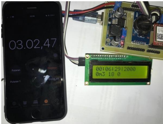
Gambar 4. 14 Pengujian Water Flow Reed Switch Sensor menit ke-3
