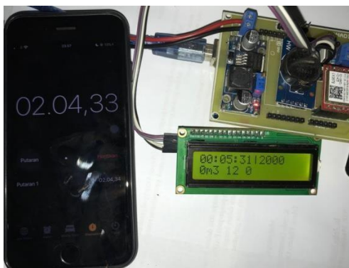
Gambar 4. 13 Pengujian Water Flow Reed Switch Sensor menit ke-2
