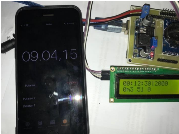
Gambar 4. 20 Pengujian Water Flow Reed Switch Sensor menit ke-9
