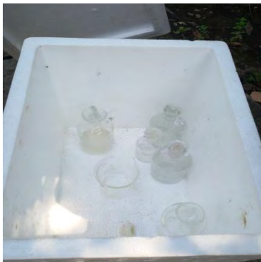
Gambar 3. Sampel greywater di Kelurahan Keputih Surabaya dimasukkan kedalam botol winkler dan box styrofoam agar terjaga kualitas sampel
