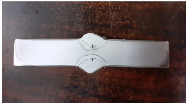
Gambar 3.16 Material Uji Kekerasan K Groove Terdapat Incomplete Penetration
