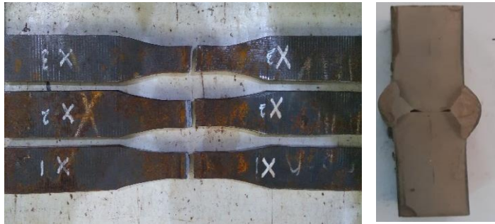
Gambar 4.3 Pengujian Tarik Pada X Groove Patah diWeld Metal
