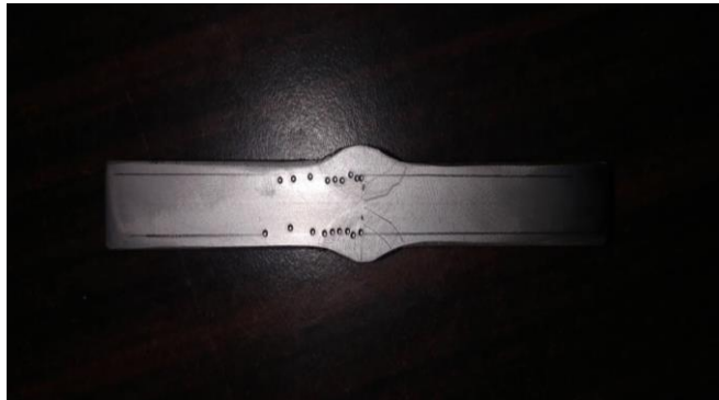
Gambar 4.5 Daerah Indentasi Untuk X Groove
