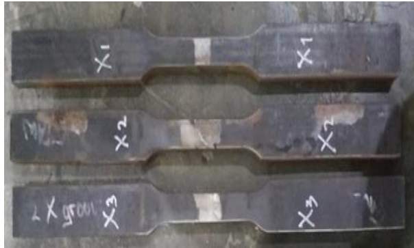
Gambar 3.15 Material Uji Tarik X Groove
