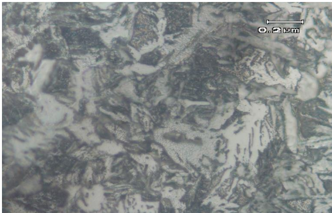
Gambar 4.11 Struktur Mikro Daerah HAZ K Groove
