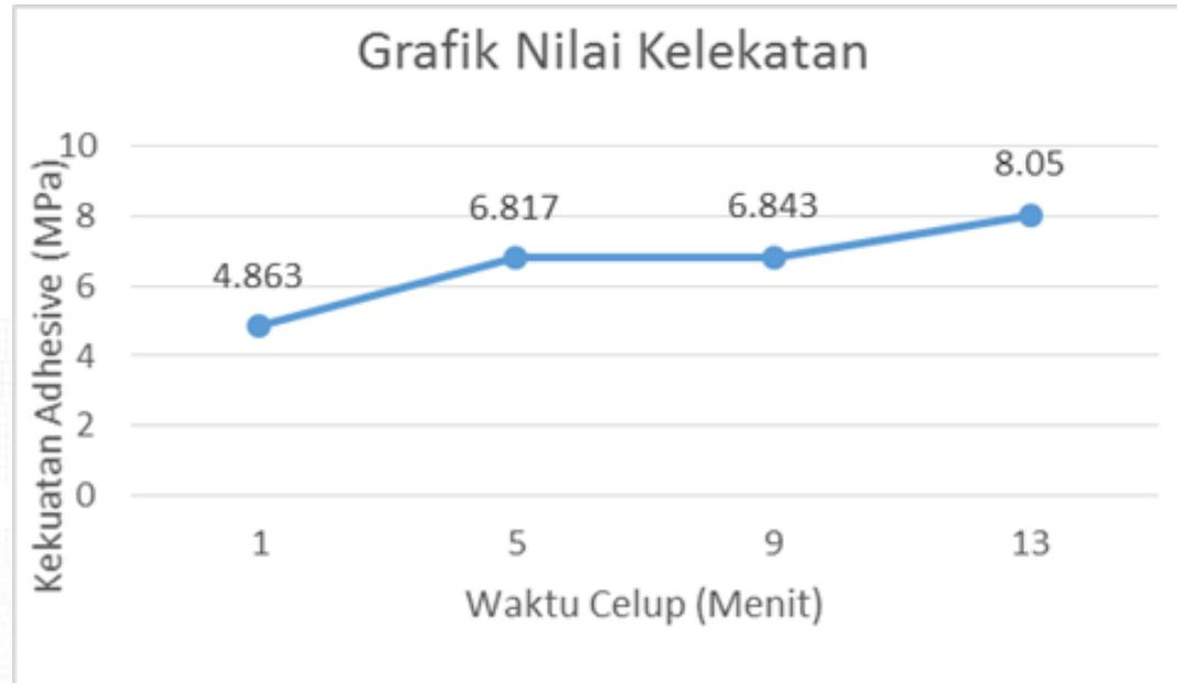
Berdasarkan data pengujian dan analisa yang sudah dilakukan, maka semua variable waktu celup (1, 5, 9, dan 13 menit) memiliki sifat adhesiv yang baik karena pengujian mekanik yang dilakukan berupa gaya tarik tidak mampu menyebabkan *adhesion failure* tetapi hanya terjadi *cohesion failure*.
