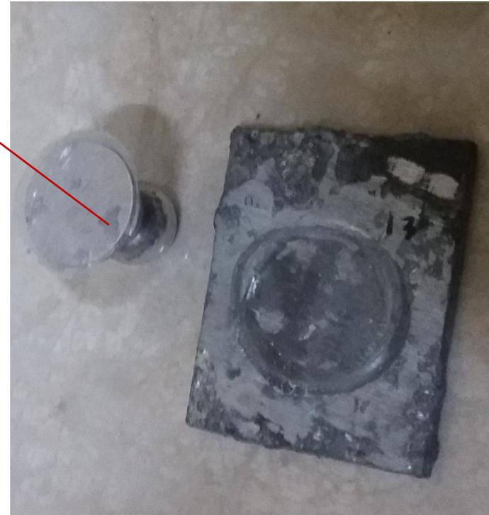
Setelah Pengujian Adhesive. Tidak terjadi Adhesion Failure.
