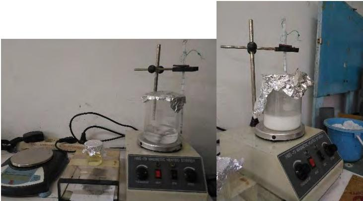
Gambar 3.12 Sintesis  $\text{TiO}_2$  dengan Metode Kopresipitasi
