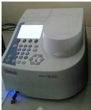
Gambar 3.16 Pengujian Spektrometer UV-Vis
