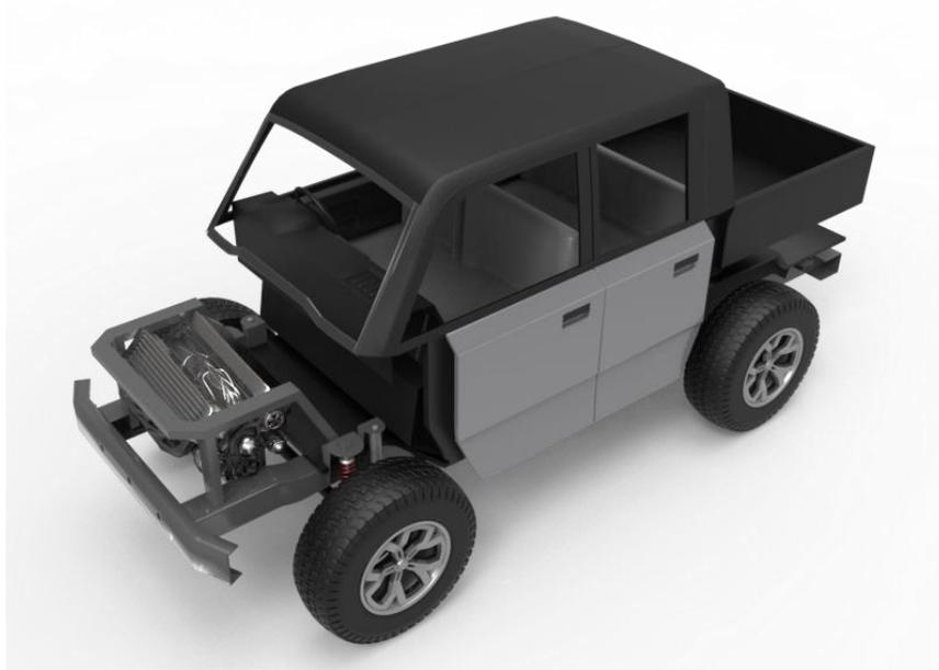
Gambar 4. 28 Pemasangan roof, rangka, dan panel pintu
