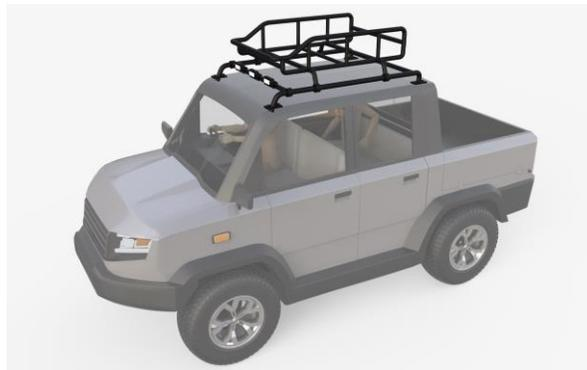
Gambar 5. 12 Desain akhir dengan modular roofrack
