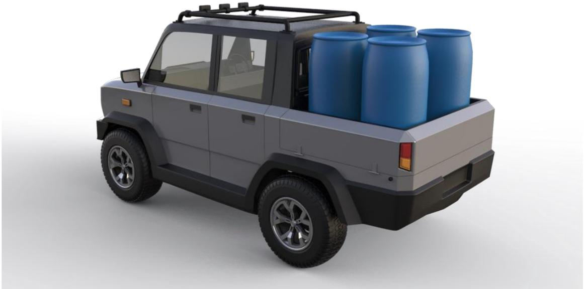
Gambar 5. 17 Skenario memuat 4 drum 120 L
