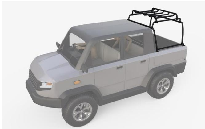
Gambar 5. 13 Desain akhir dengan extended cargo
