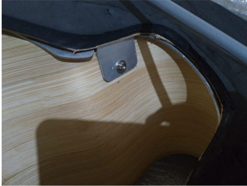
Gambar 5. 87 Mounting besi dengan Bambu (Sumber: Dok. Pribadi)
