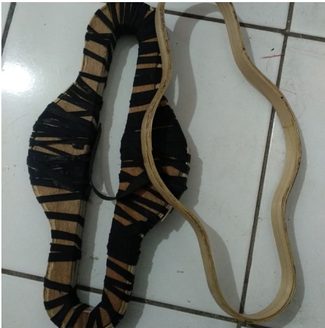
pengikatan bambu sebagai metoda press cetakan
