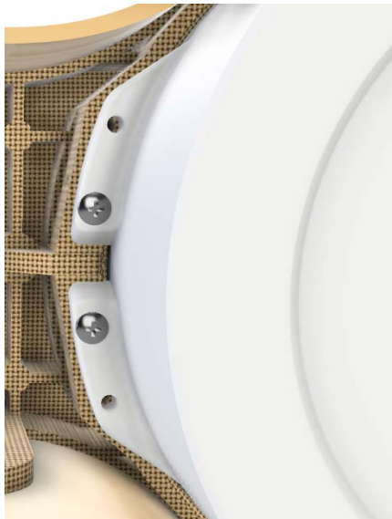
Gambar 5. 32 Pemasangan Speedometer utama pada Innerframe (Sumber: Dok. Pribadi)
