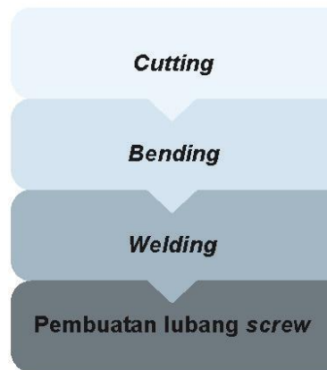
Gambar 46.20 Alur Pembuatan Solid Mold (sumber: penulis, 2020)
