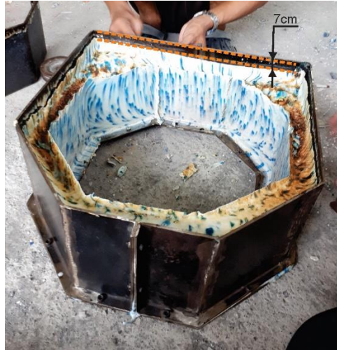
Gambar 53.2 Penyusutan Plastik pada Proses Pengovenan (sumber: penulis, 2020)
