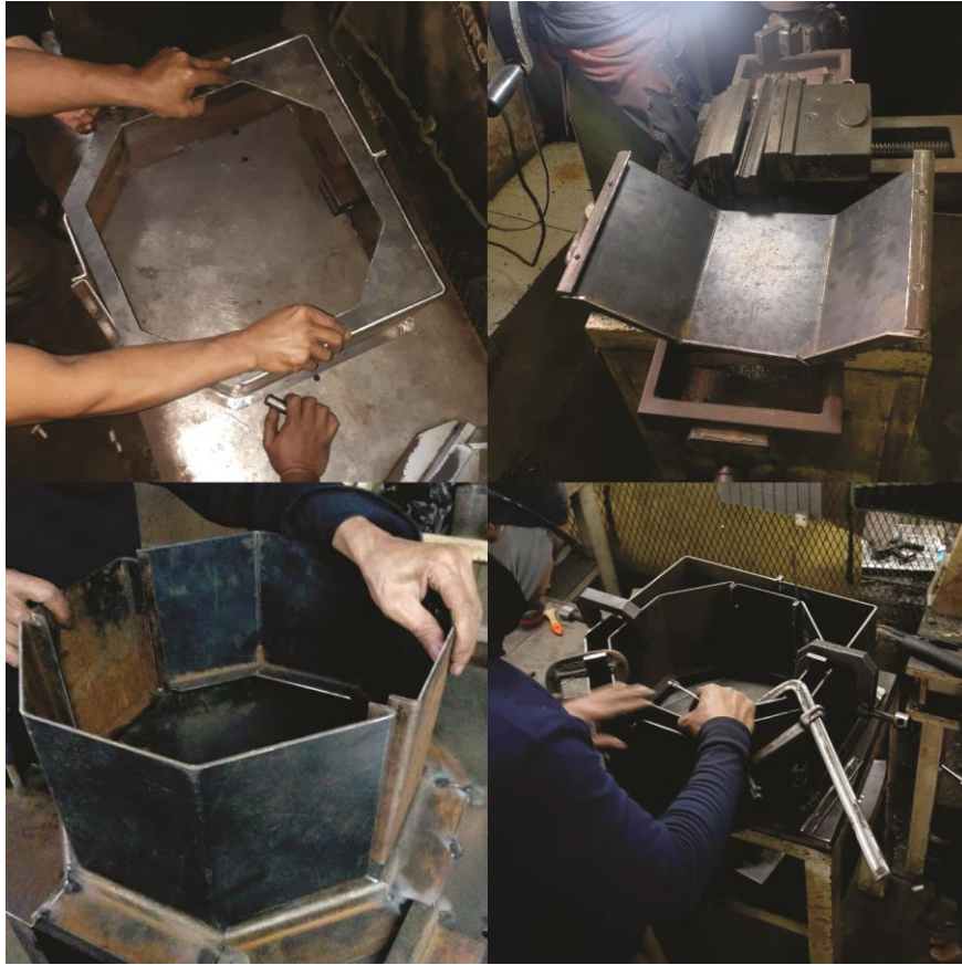
Gambar 47.21 Proses Pembuatan Solid Mold (sumber: penulis, 2020)
