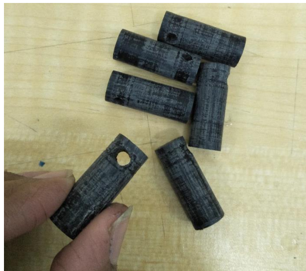
Gambar 56.5 Sistem Sambungan Menggunakan Dowel oleh Priandika (2019) (sumber: Priandika,2019)
