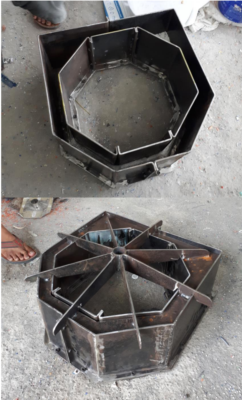
Gambar 48.22 Hasil Akhir Solid Mold (sumber: penulis, 2020)
