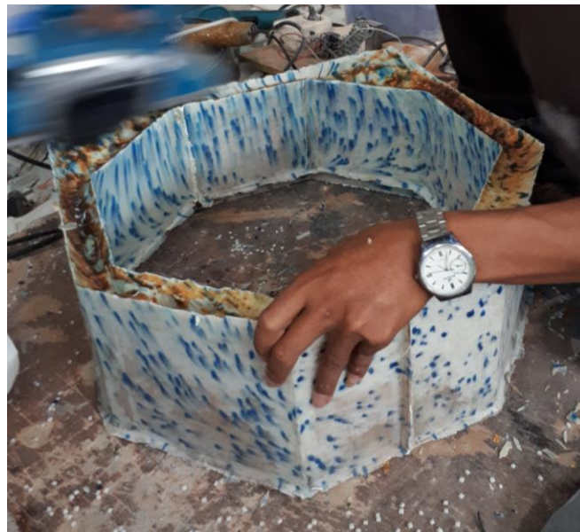
Gambar 45.19 Hasil Akhir Solid Mold (sumber: penulis, 2020)
