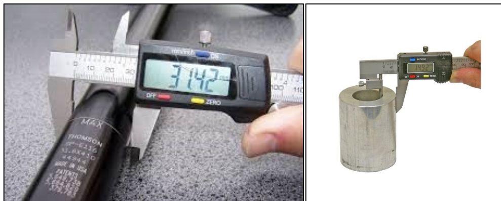
Gambar 3.9 Pengukuran OD dan Thickness Tube Sampel
