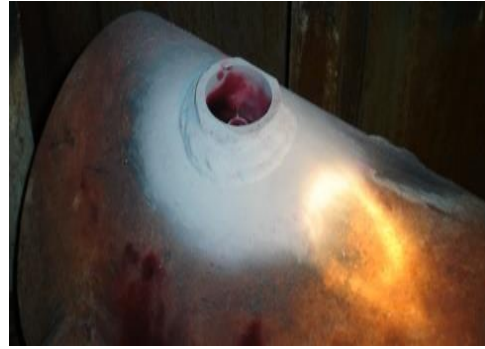
Gambar 2.11: Kerusakan tube akibat fatigue thermal expansion
