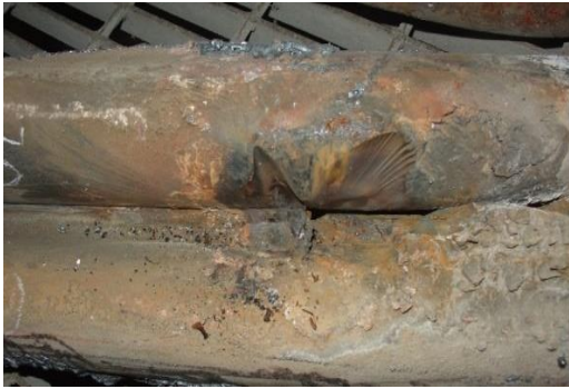
Gambar 2.11: Kerusakan tube akibat fatigue thermal expansion
