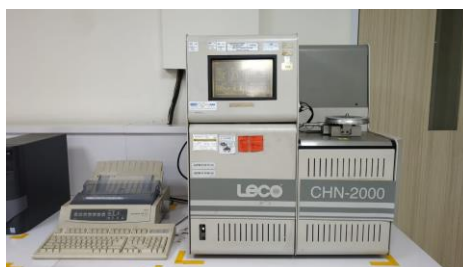
Gambar 3.7 Elemental Analyzer Leco CHN-2000
