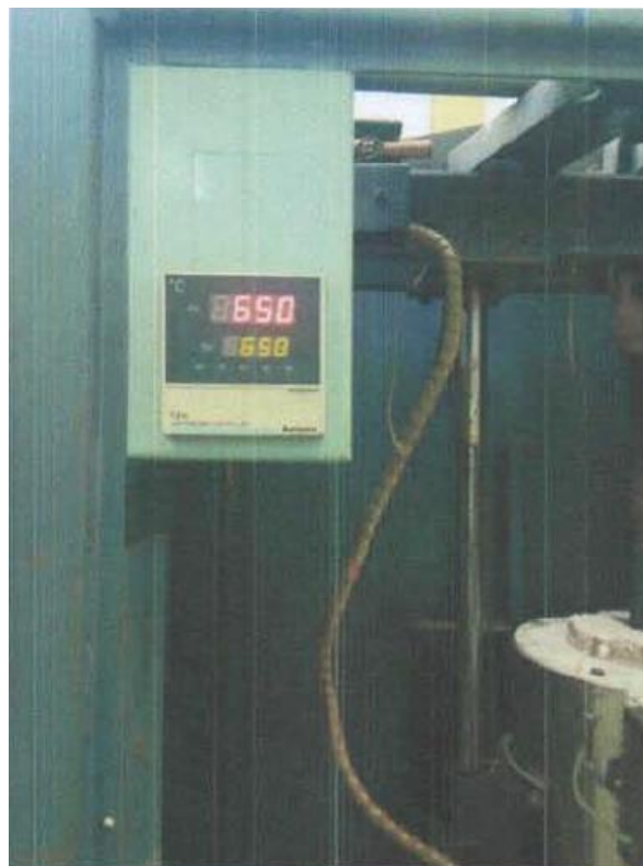
Lampiran 5. Pengoperasian uji creep pada temperatur 650°C
