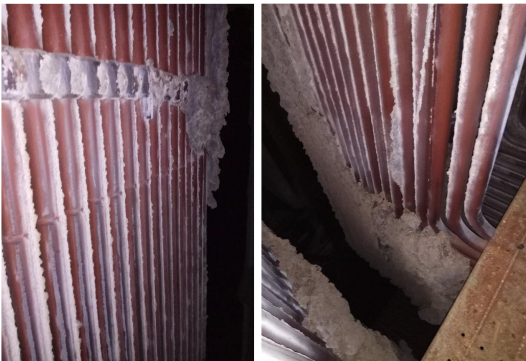
Gambar 4.3 Abu yang Menempel pada Superheater Tube
