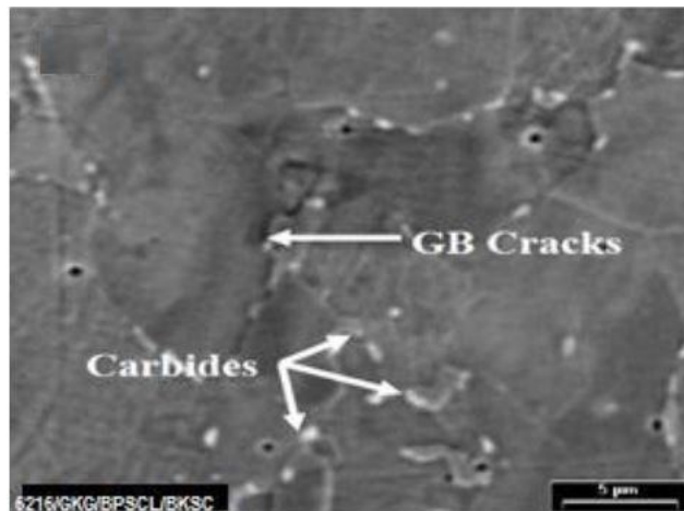
Gambar 2.16 SEM Mikrograf Bagian Melintang dari Tabung yang Rusak Sampel A2 (Gupta dan Chattopadhyaya, 2017)
