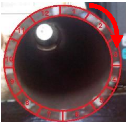
Lampiran 9. Hasil Pengukuran Ketebalan Tube untuk dihitung sisa umur
