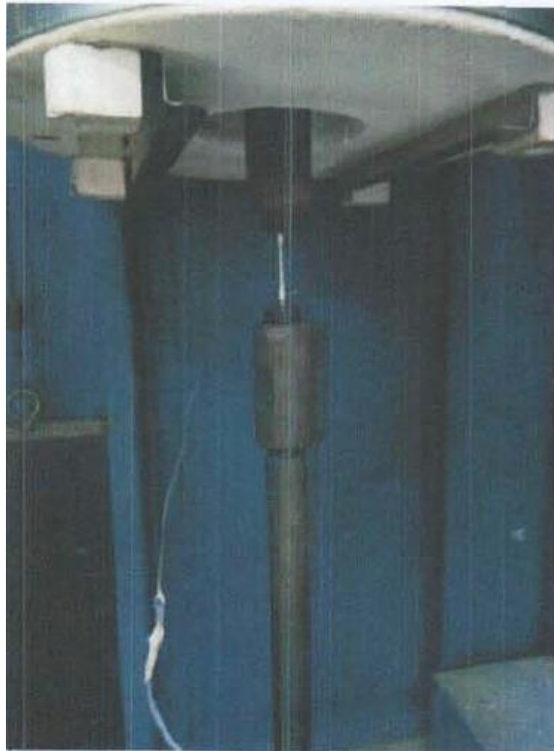
Lampiran 5. Pengoperasian uji creep pada temperatur 650°C
