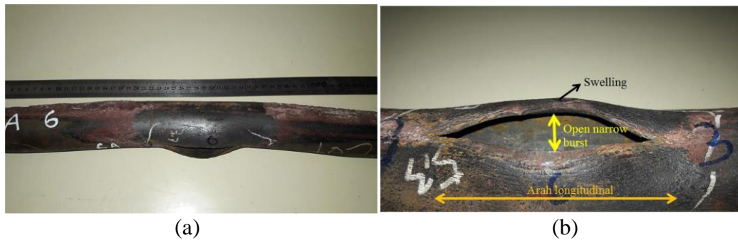
Gambar 4.8 Tube Code 6 yang Mengalami Rupture; (a) Tampak Samping; (b) Tampak Depan
