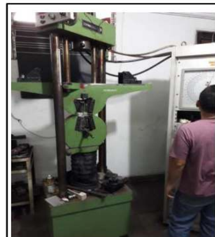
Gambar 2.9 Proses Uji Tarik
