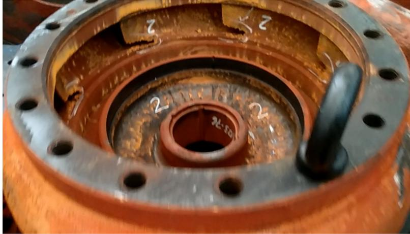
Gambar 1.2 Erosi kavitasi pada *second stage bowl diffuser* CEP 2B.
