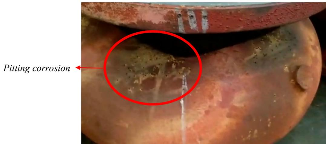
Gambar 1.4 *Pitting corrosion* pada *bowl impeller* menembus bagian luar
