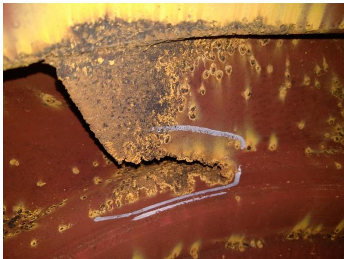
Gambar 1.3 Erosi kavitasi pada *guide bowl impeller*
