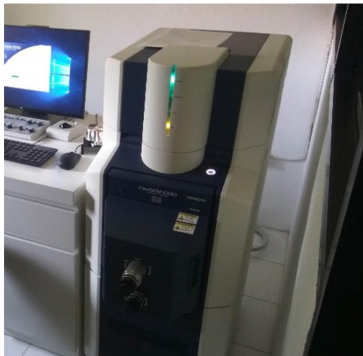
Gambar 3.12. Scanning Electron Microscope Hitachi FlexSEM 1000 dengan EDS dari EDAX system.
