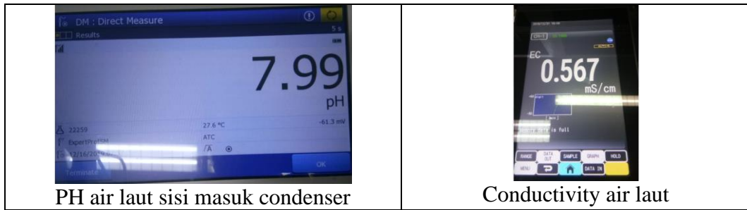
Gambar 3.22 Hasil Analisa air laut sisi masuk condenser Unit 1 PLTU Labuan
