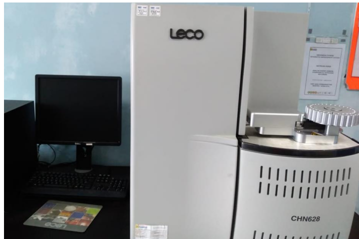
Gambar 3.3 Foto Salah Satu Alat Analisa Batubara LECO CHN628.
