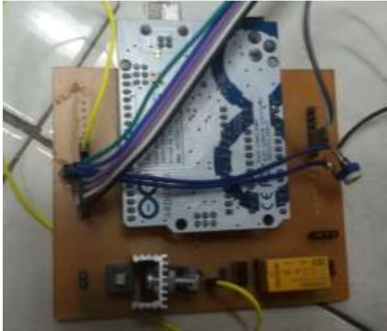
Gambar IV.27 Realisasi rangkaian automatic control system tampak atas Sumber: dokumentasi pribadi
