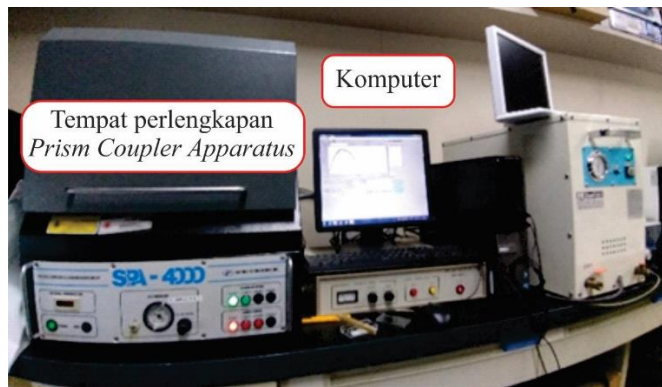
Gambar 3.7 Perangkat Prism Coupler Apparatus di Universitas Kumamoto
