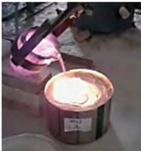
Gambar 3.8 Proses penuangan logam cair ke dalam cetakan.
