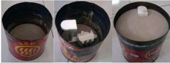
Gambar 3.7 Proses pengisian cetakan.
