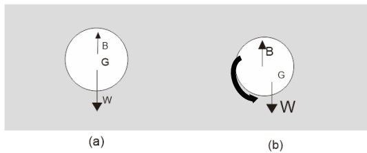
Gambar 2.3 Tubuh benda terendam stabil secara rotasi
