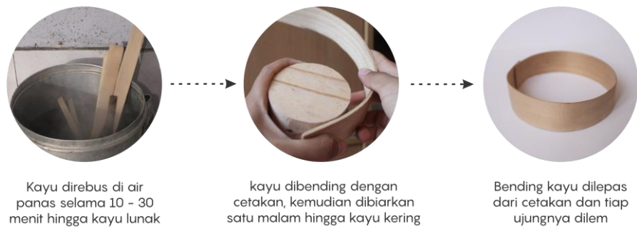
Gambar 4. 12 proses eksperimen soft wood bentuk lingkaran
