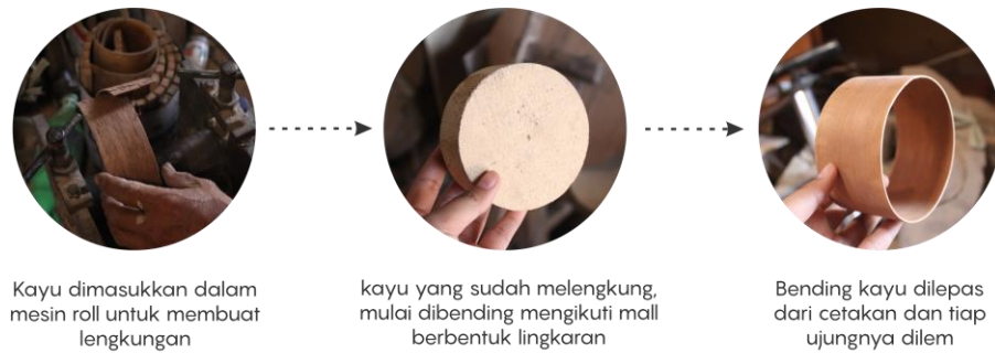
Gambar 4. 18 proses eksperimen bending hard wood bentuk lingkaran (Sesaria, 2019)
