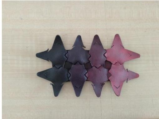
*Gambar 4. 16 Pola yang dihasilkan dari interlock modul 4 menggunakan laser cutting (Sumber : Putri, 2019)*
