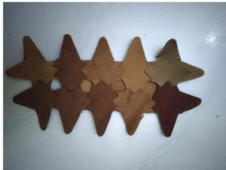
*Gambar 4. 17 Pola yang dihasilkan dari interlock modul 4 menggunakan mesin plong (Sumber : Putri, 2019)*
