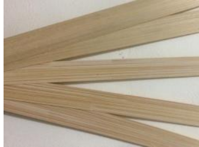
Gambar 4. 7 Iratan bambu apus yang digunakan saat proses bending
