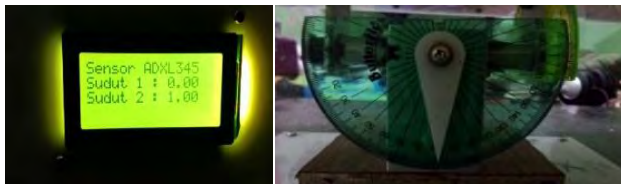
Gambar 4.6 Pengujian Sensor Accelerometer ADXL345
