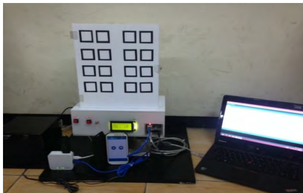
Gambar 4.9 Pengujian Keseluruhan Alat Monitoring Kemiringan Bangunan Menggunakan Accelerodengan Media Komunikasi Bluetooth dan Wifi
