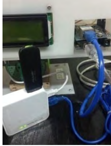
Gambar 4.5 Koneksi antara Ethernet Shield dengan Router
