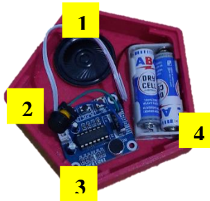
Gambar 4. 4 Rangkaian Listrik dalam Potongan Puzzle (Sumber: Penulis, 2020)
