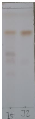
Gambar 4.20 Kromatogram KLT fraksi I5 dan J2 dengan eluen etil asetat : n -heksana (2:3) v/v
