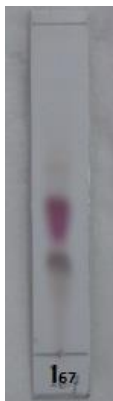
Gambar 4.16 Kromatogram KLT fraksi gabungan I6 dan I7 dengan eluen etil asetat : n -heksana (1:3) v/v
