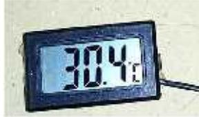
**Gambar 9.** Thermometer Digital**Spesifikasi :**
