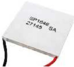
**Gambar 12.** Modul TEG yang di uji
