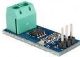
**Gambar 2.7** Sensor Arus IC ACS712
