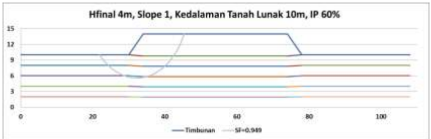
Gambar 5.6 Garis Kelongsoran yang dihasilkan pada Analisa Stabilitas H final 4 meter, Slope 1, Kedalaman Tanah Lunak 10 meter, IP 60% pada Asumsi Kondisi Tanah Telah Memampat
