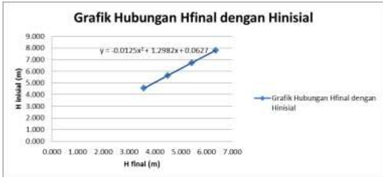
Gambar 4.1. Grafik Hubungan antara Hfinal dan Hinisial untuk Ketinggian Timbunan yang Bervariasi, slope 1, dan kedalaman tanah dasar 20 meter
