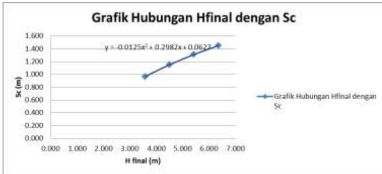
Gambar 4.2. Grafik Hubungan antara Hfinal dan Sc untuk Ketinggian Timbunan yang Bervariasi, slope 1, dan kedalaman tanah dasar 20 meter
