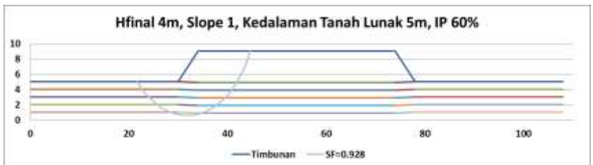
Gambar 5.5 Garis Kelongsoran yang dihasilkan pada Analisa Stabilitas Hfinal 4 meter, Slope 1, Kedalaman Tanah Lunak 5 meter, IP 60% pada Asumsi Kondisi Tanah Telah Memampat
