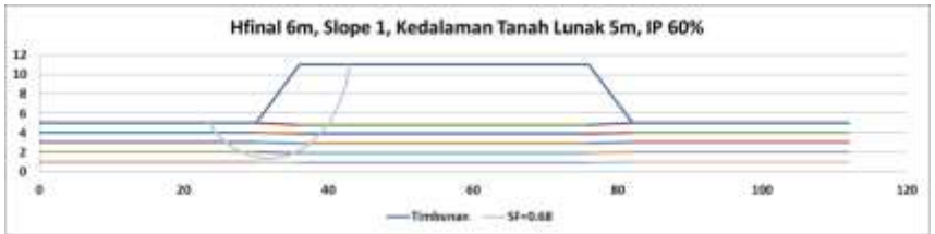
Gambar 5.17 Garis Kelongsoran yang dihasilkan pada Analisa Stabilitas Hfinal 6 meter, Slope 1, Kedalaman Tanah Lunak 5 meter, IP 60% pada Asumsi Kondisi Tanah Telah Memampat
