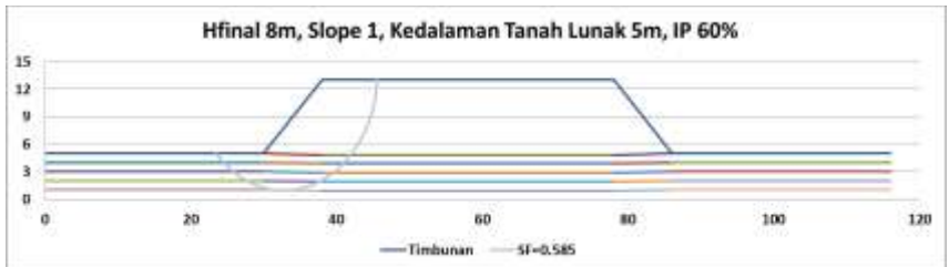
Gambar 5.30 Garis Kelongsoran yang dihasilkan pada Analisa Stabilitas Hfinal 8 meter, Slope 1, Kedalaman Tanah Lunak 5 meter, IP 60% pada Asumsi Kondisi Tanah Telah Memampat
