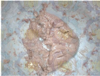
Gambar 4.33 Pasta Dengan Binder Metakaolin 75% terhadap Lusi
