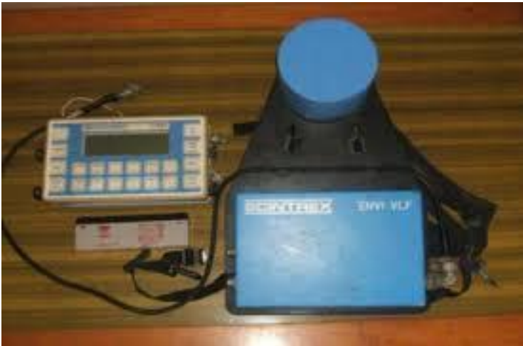
Gambar 3. 2 Alat VLF-EM yaitu ENVI VLF dibuat oleh Scintrex
