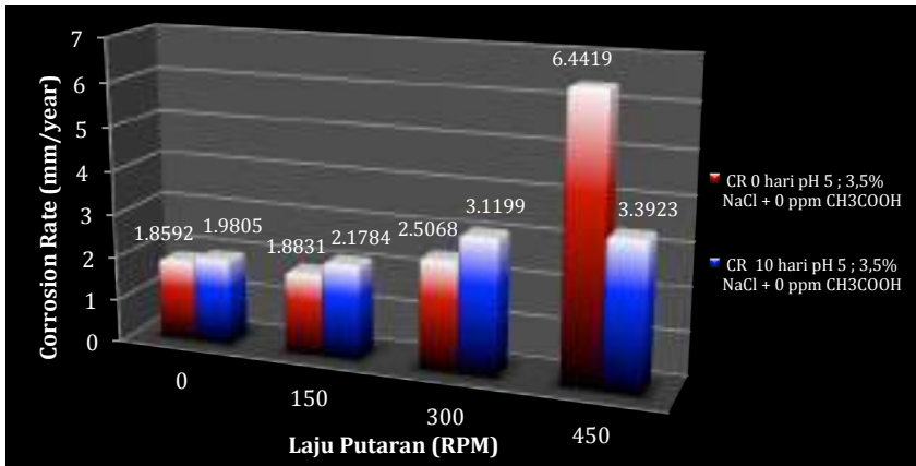
Gambar 4.17 Grafik tren corrosion rate terhadap fungsi waktu Baja ASME SA516 grade 70 pada pH 5 larutan 3,5% NaCl + 0 ppm CH 3 COOH
