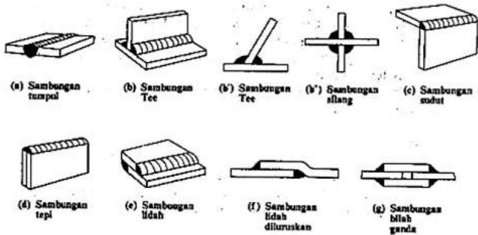
Gambar 2.9 Jenis-jenis sambungan dasar (Harsono Wiryosumarto, Toshie Okumura, 1996)
