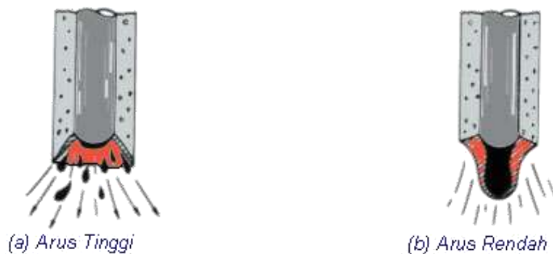
Gambar 2.3 Pemindahan Logam Cair (Harsono Wiryosumarto, Toshie Okumura, 1996)
