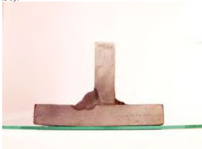
Gambar 3.36 Perletakkan spesimen uji diatas kaca untuk pengukuran distorsi (sumber: dok.pribadi)
