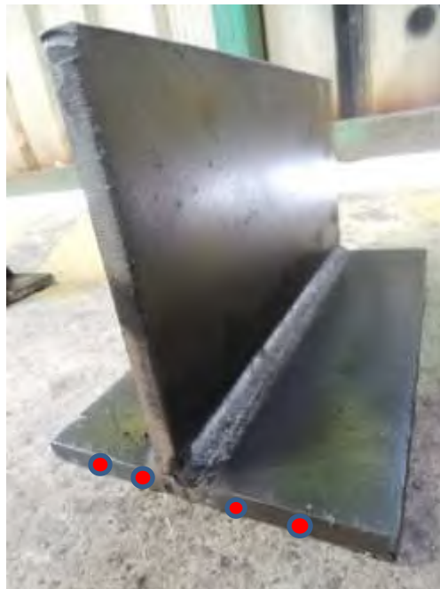
Gambar 3.30 Hasil pengelasan pada pelat yang diberi titik untuk menghitung perubahan distorsi (sumber: dok.pribadi)
