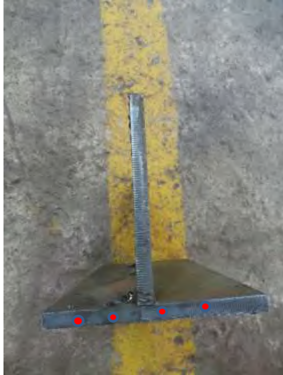
Gambar 3.29 Proses Penandaan Plat dengan Memberi Titik-titik Pada Plat yang Akan Dihitung Perubahan Distorsi (sumber: dok.pribadi)
