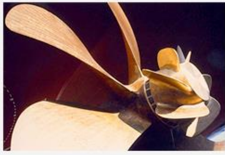
Gambar 2.1 Sirip / fins pada Boss Propeller
