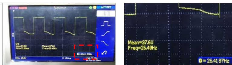
Gambar 4.3 Frekuensi Listrik pada duty cycle PWM 55%
