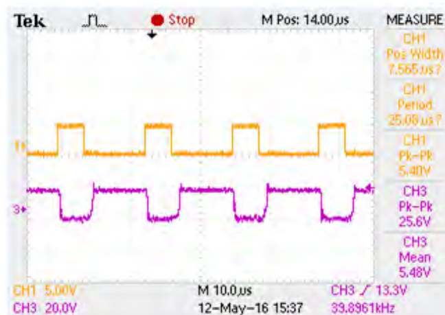
Gambar 4.22. Sinyal PWM dan V_{DS} MOSFET pada duty cycle 0,3
