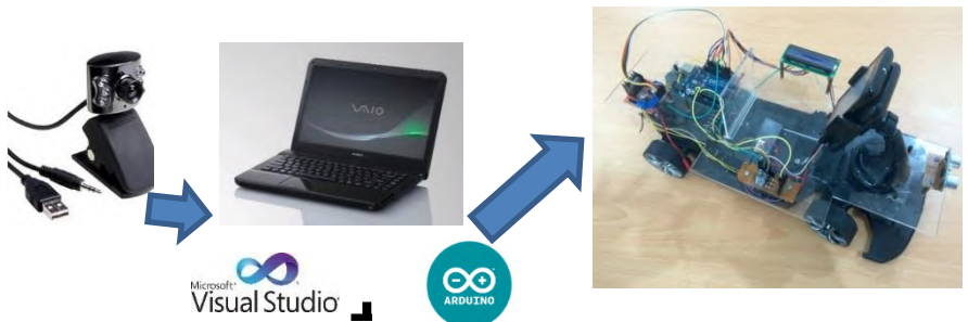
Gambar 4.26 Komunikasi antara kamera dengan self-driving remote control car .
