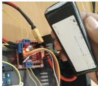
Gambar 4.15 Baterai lipo dengan motor driver dihubungkan.
