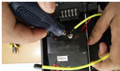
Gambar 4.13 Antena penerima sinyal dilepas.
