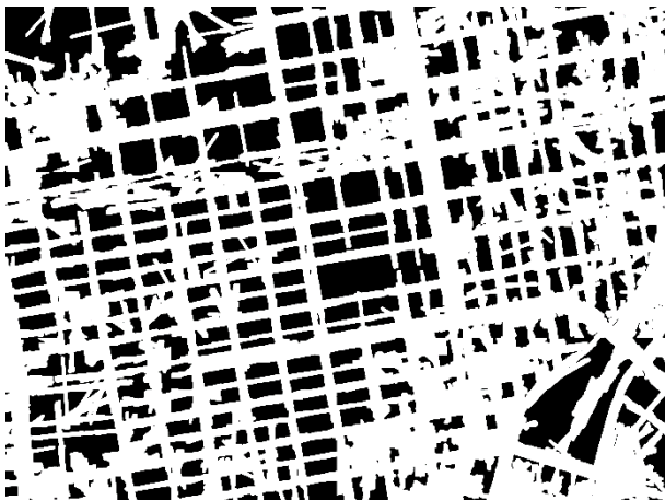
Gambar Lampiran 3. 6. Hasil Skenario 3, Nilai threshold 1 sampai 0,3 dari jumlah zebra cross yang terdeteksi pada metode Threshold , Nilai threshold 7 pada metode Region growing
