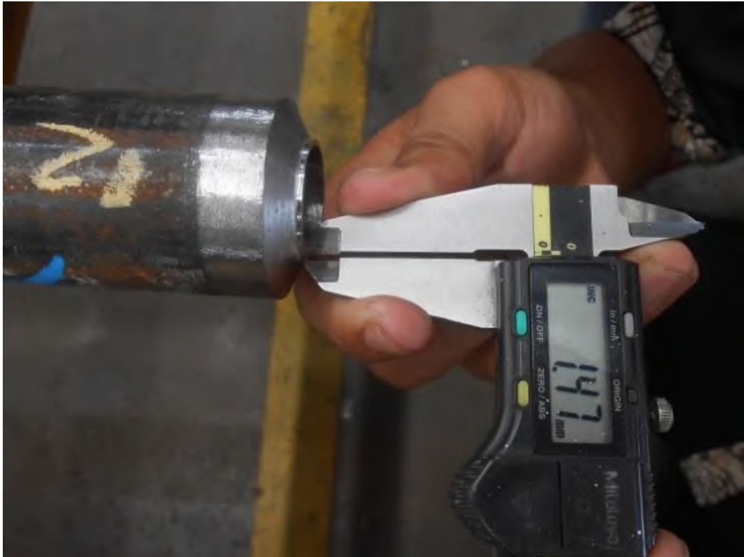
Gambar 4.8. Pengecekan pekerjaan fitter .(koleksi pribadi)
