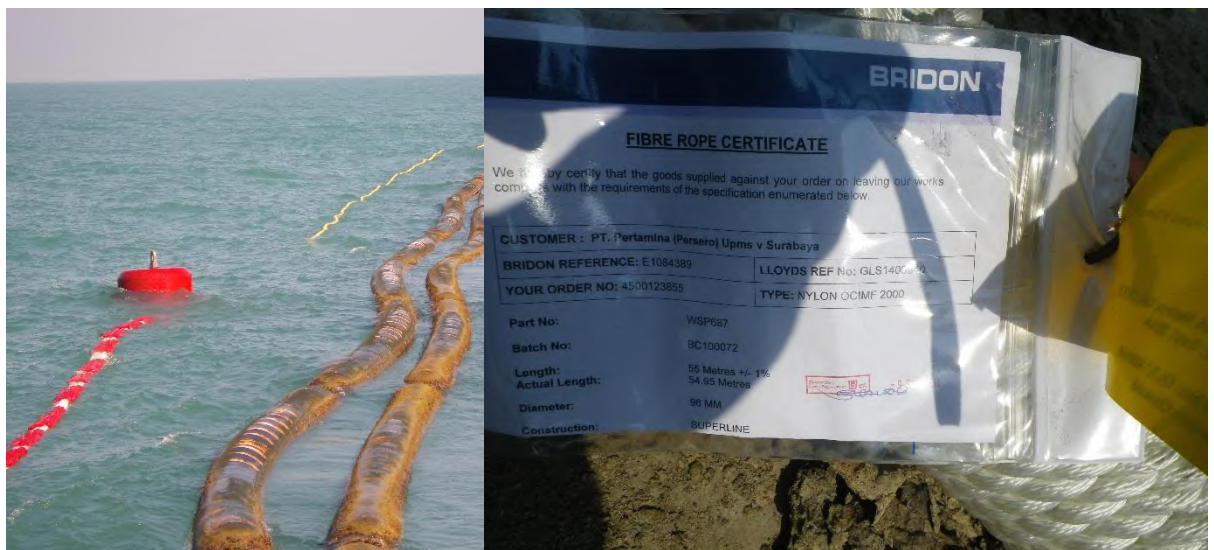
Gambar 4.26. Mooring Hawser dan spesifikasi wire rope (Dokumentasi Pribadi)
