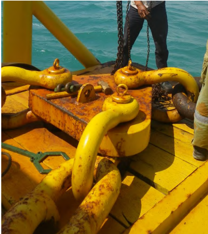
Gambar 1.2. Triangular plate yang merupakan komponen mooring system pada SPM 035 Pertamina TBBM Tuban (Dokumentasi Pribadi)
