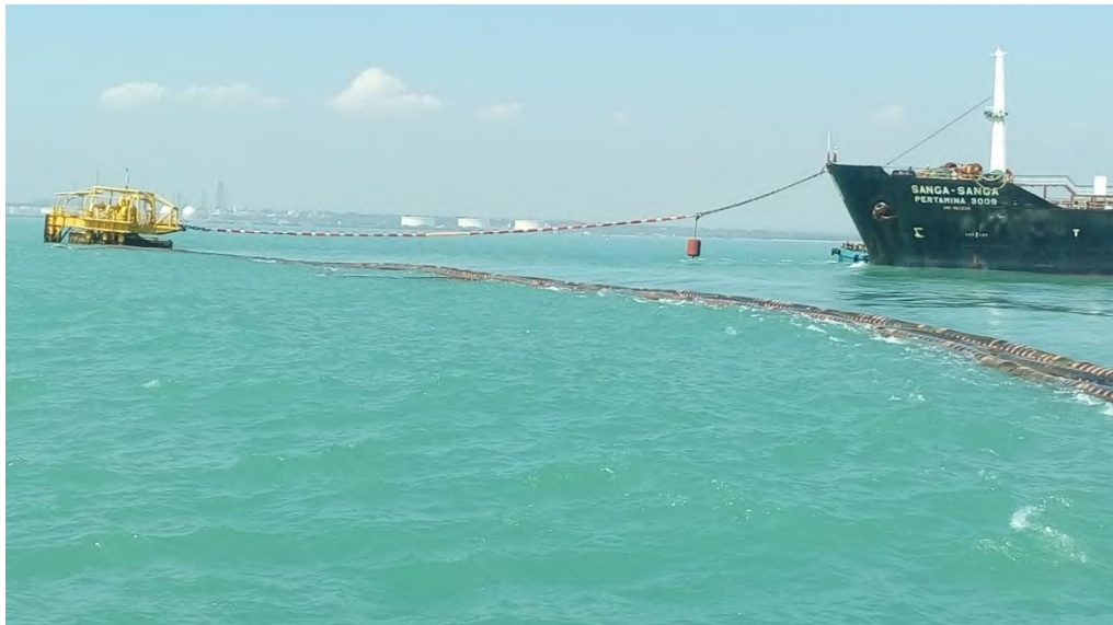
Gambar 4.12. Penambatan tanker di SPM dengan mooring system (Dokumentasi Pribadi)
